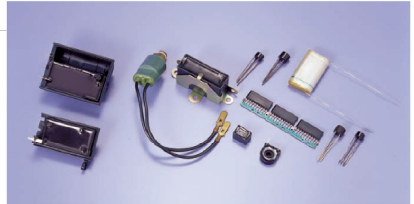
液状エポキシ樹脂製品が使用されている各種電子部品、電子機器 Various electronic and electrical components, insulated by liquid epoxy product.
